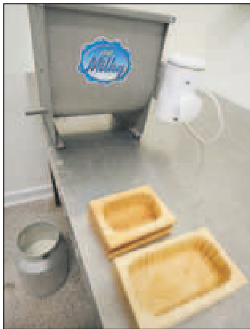
Strojček za izdelavo masla in pri Ribničanih narajeni šabloni za oblikovanje izdelka
